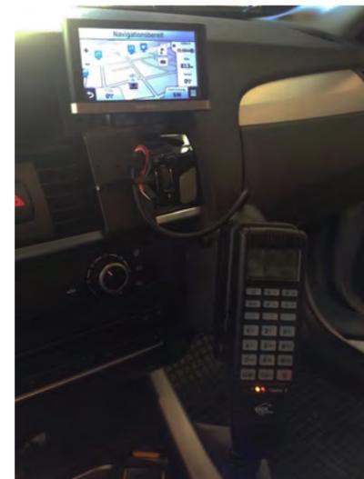
Navigationsgerät und Funk im Notarzteinsatzfahrzeug.
